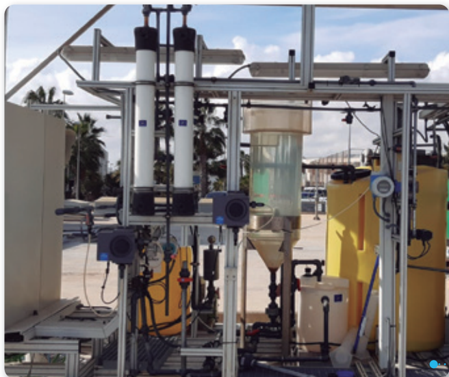
Sistema de filtración – decantación para tratar las corrientes de agua de limpieza con alta carga en sólidos | Filtration – settlement system to treat cleaning water streams with high solids load
